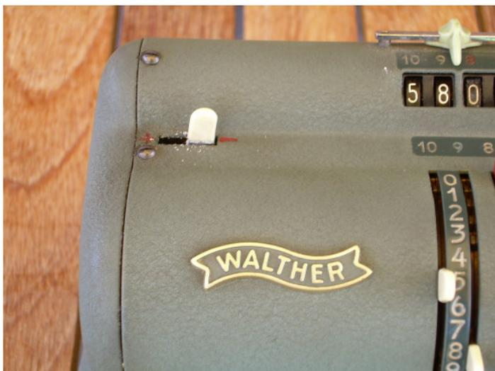
Nun wird die erste ungerade Zahl eingestellt, hier die 1. Man beachte, dass die Einteilung in Zweierblocks dazu geführt hat, dass der höchstwertige lediglich aus einer Ziffer (hier der 5) besteht.
