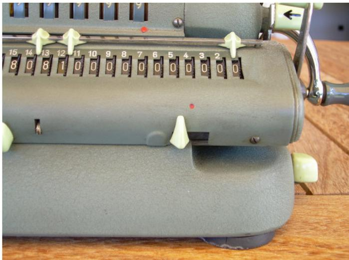
Bei Betätigen des Löschehebels wird hierdurch verhindert, dass das Resultatwerk ebenfalls gelöscht wird.
