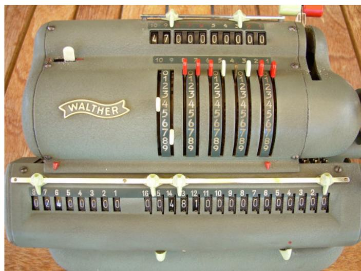
Die Subtraktion der 51 wäre nicht mehr möglich. Daher wird der Wagen wiederum um eine Stelle nach links verschoben. Im nächsten Schritt erfolgt dann die Subtraktion der 241-ten ungeraden Zahl (man beachte, dass man dies im Umdrehungszählwerk links ablesen kann; um 1 inkrementierte angezeigte Zahl).
