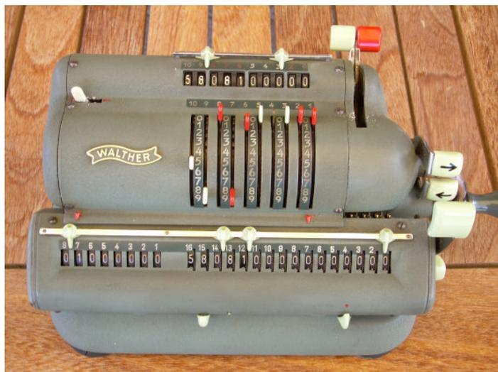
Im Umdrehungszählwerk ist dadurch eine 1 an der Position ,7' entstanden. Diese muss gelöscht werden. Bei der Walther WSR 160 muss hierzu vor Betätigung des Löschehebels am Schlitten der kleine Schieber auf der rechten Seite des Schlittens nach links gestellt werden.
